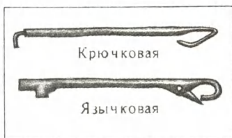
Используемые в трикотажном производстве вязальные иглы
